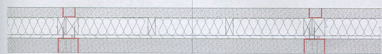
Lehmelement Leicht - Außen Wärmedämmung (Holzfaser, Hanffaser, ...) Ständerkonstruktion (KVLH, je nach stat. Erfordernis) Rauschalung Diagonal Lehmelement Schwer - Innen
